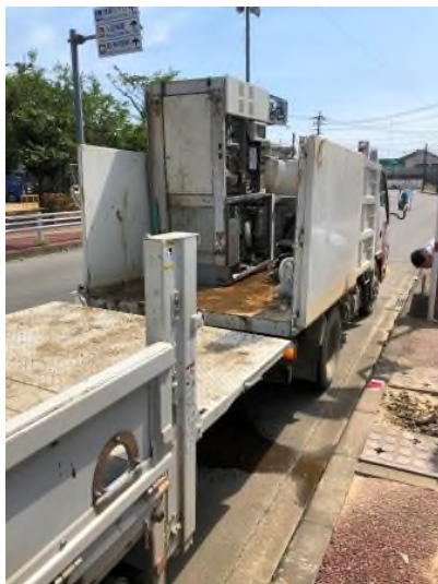
パワーゲート付きトラックを活用したダンプ車への積込作業
