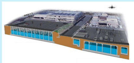
例:大和川水系大和川 奈良県田原本町 社会福祉協議会駐車場他地下貯留施設整備
