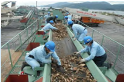
二次選別プラントの手選別ライン
