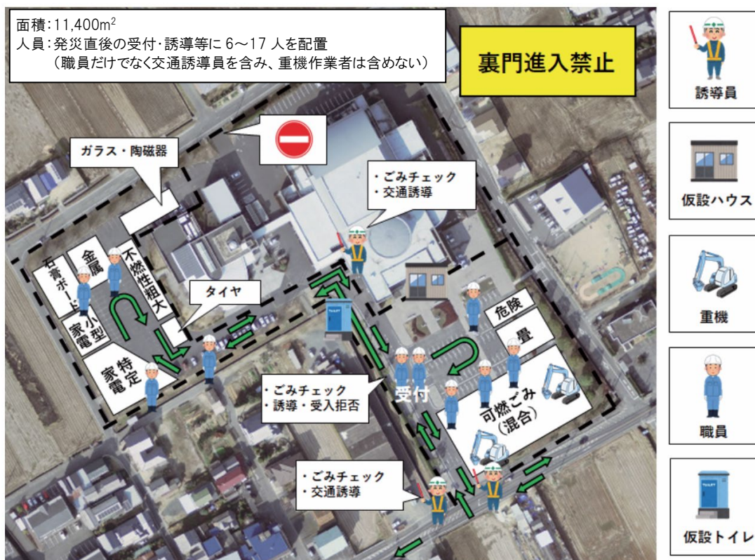
図 3-2 一次仮置場設置事例 (平成 30 年 7 月豪雨 倉敷市マービーふれあいセンター)
