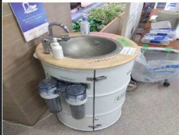
水循環型手洗いスタンド（志賀町）
