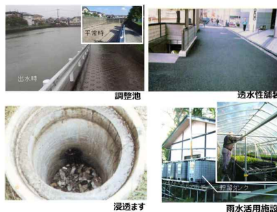
雨水貯留浸透施設の例
