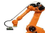
ピッキングロボット
