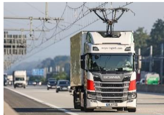
接触給電技術の例(ドイツ eハイウェイ)
