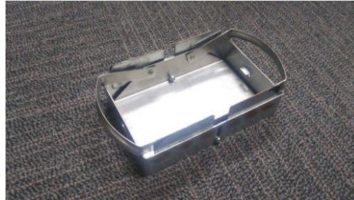
写真 1-1 改良した足くりわな (約 98mm × 210mm)
