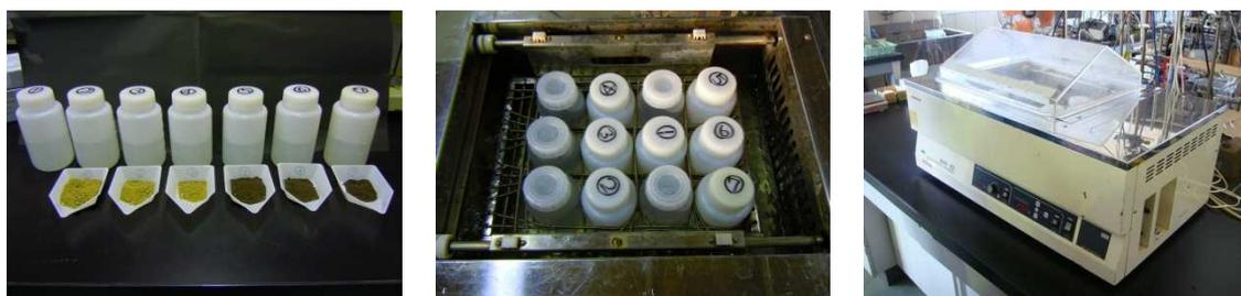
(a) 試料投入時                      (b) 恒温槽に設置                      (c) 24 時間 120rpm 振とう
