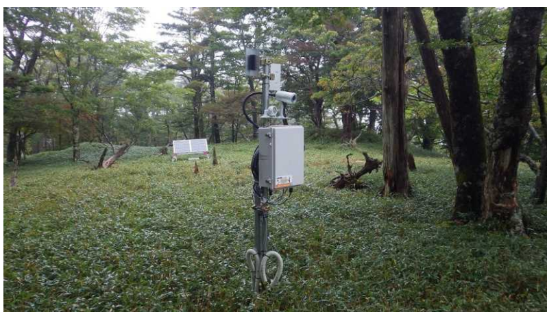
図8 罾の遠隔監視用カメラ等
