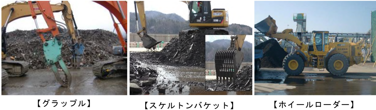
図 4.2.2 仮置場で使用する重機例
