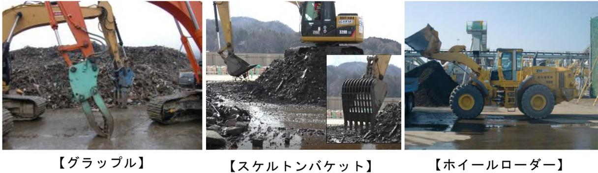
図 4.2.2 仮置場で使用する重機例
