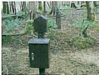
入下山カウンターの設置状況
