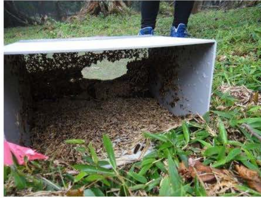
三津河落山試験区のササ刈り区に設置した土砂受け箱内に溜まった土壌とリター
