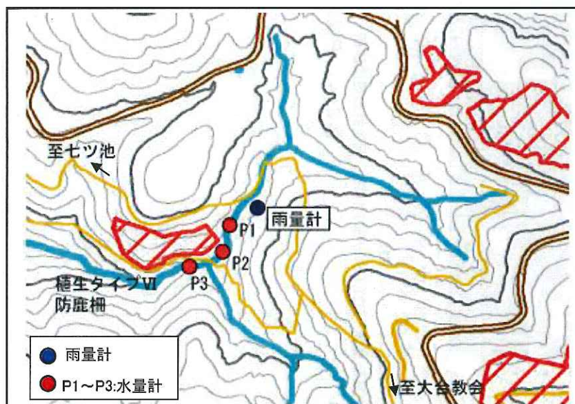
図2 ナゴヤ谷における水位計、雨量計の設置地点（詳細）
