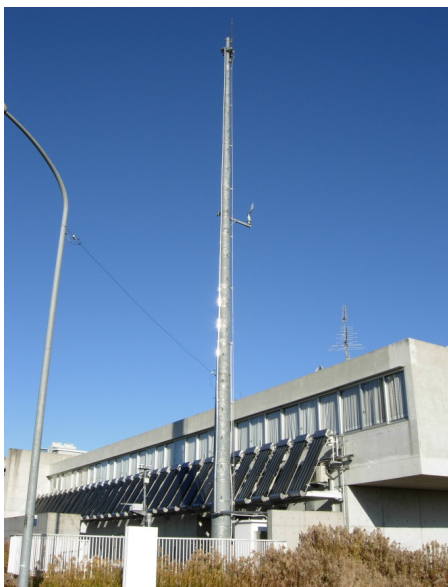
埼玉県のモニタリングポスト (WMO標準ガスによる校正を行っている)
