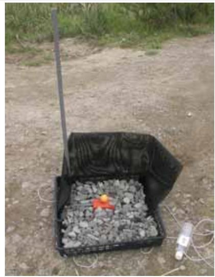
リセット式センサー全体（右）、中央にセンサーを設置。糸はし字型プラスチック管中の金属棒と連結する（下）。
