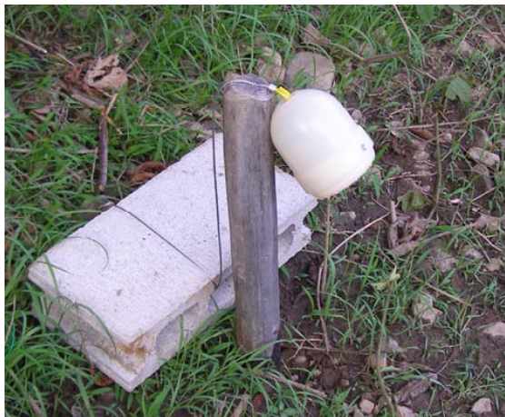
写真1 杭を用いた設置
