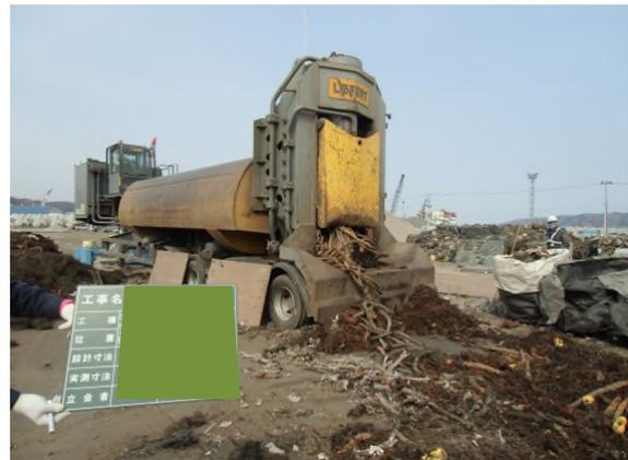
ギロチン式裁断機による細断
