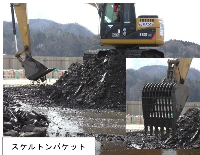
図 4.2.2 仮置場で使用する重機例
