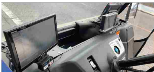
メーターやナビなどが設置された
